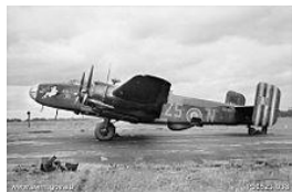
Cet Handley Page Halifax-B Mark III du 462 Squadron de la Royal Australian Air Force en 1945 a appartenu au Groupe 100 RAF spécialisé dans la protection des raids de bombardements stratégique Alliés en Europe. Sous son fuselage se trouve du matériel de brouillage radar et de contre-mesures.
