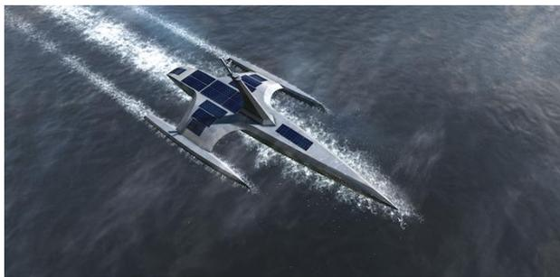
équipé d'un moteur biodiesel prêt à prendre le relais au cas où il n'y aurait pas assez de soleil pour l'alimenter.
