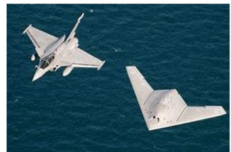
Tous les tests ont été réussis : simulation d'approche, haute vitesse, virages, capacité à s'aligner sur la piste et à se poser automatiquement. Ces tests ont démontré notamment la maîtrise des commandes de vol dont certaines parties sont issues du jet d'affaires, le Falcon 7X.
