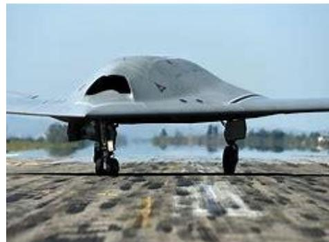
Le Dassault Neuron (*ou nEUROn selon la typographie utilisée par son constructeur*) est un démonstrateur de drone de combat (UCAV) furtif français se basant sur l'aile volante et dont la maîtrise d'œuvre est confiée à Dassault Aviation. Il reprend une aérodynamique similaire au bombardier Northrop Grumman B-2 Spirit.
