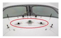
Des capteurs sont utilisés pour une vision à 360°.
