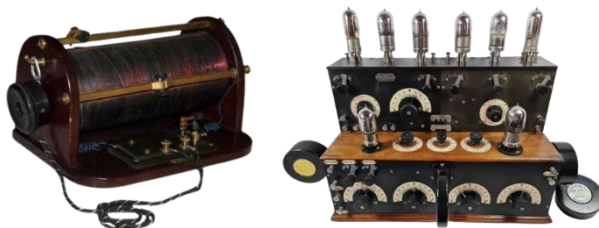
Récepteur Ducretet à droite et récepteur à galène à gauche
